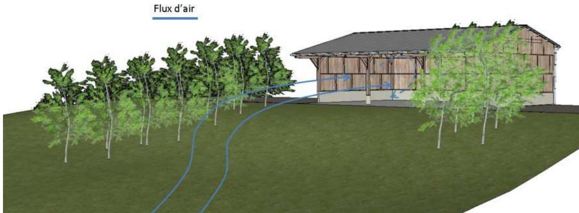
Sur ce schéma, nous pouvons comprendre comment va agir le vent avec un effet couloir qui va rebondir sur, ou dans, le bâtiment. Une telle implantation demandera d'avoir une protection naturelle en avant à une distance de 15 à 20 m.
