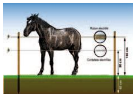
Dispositif de clôture proposé dans les corridors écologiques
